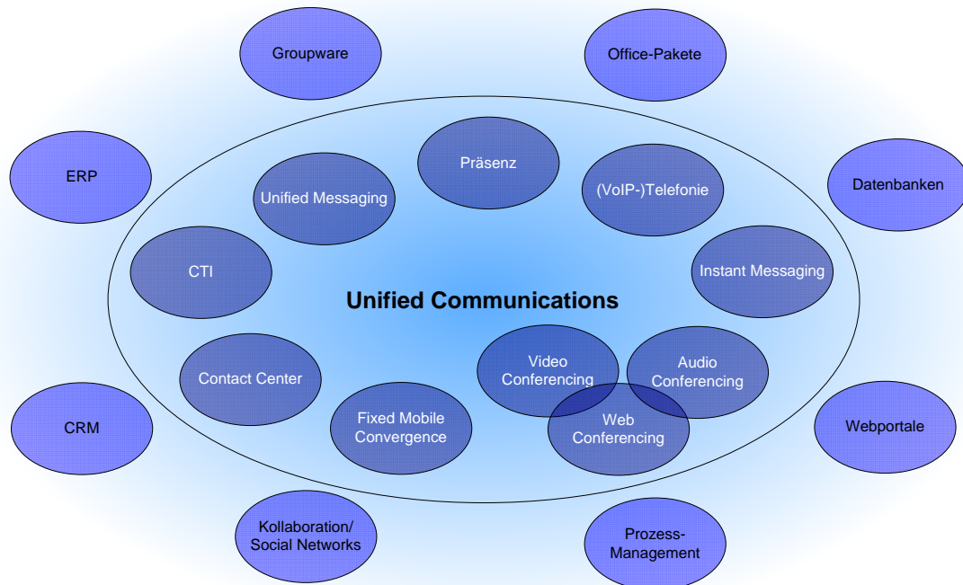
Abbildung 1: Komponenten von Unified Communications und integrations-relevante Applikationen
